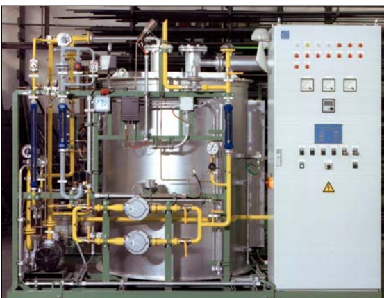
Abbildung: Endogasgenerator der Gebrüder Hammer GmbH
